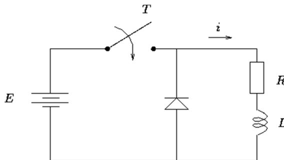
A corrente elétrica presente no diodo ideal no intervalo de tempo  $t \geq t_2$  é dada por
