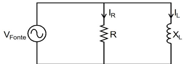
Os valores da potência ativa, potência reativa, corrente elétrica no resistor e corrente elétrica no indutor são, respectivamente,
